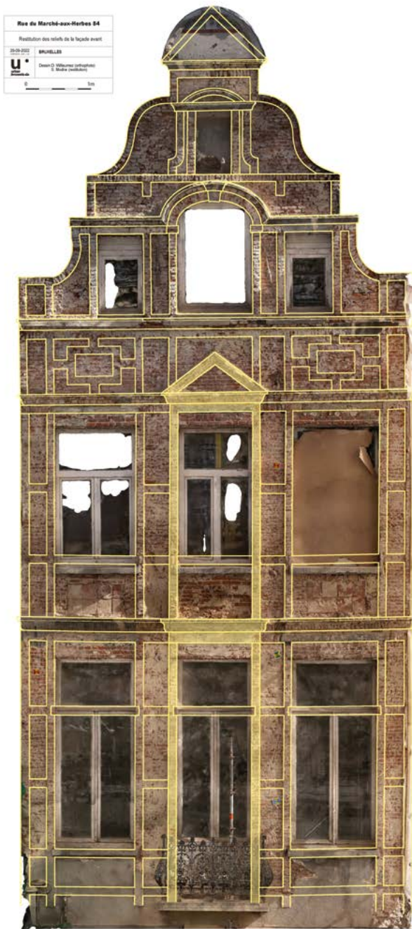
Fig. 1 Restitution de la façade rue du Marché-aux-Herbes 84 à Bruxelles (orthophoto et DAO, D. Willaumez © urban.brussels-ULiège).
