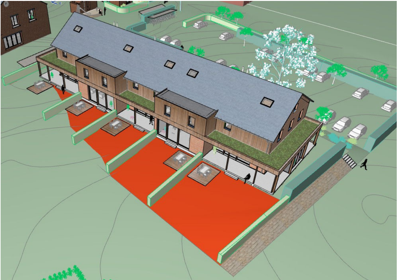
Illustration 4: mise en évidence de la modification des courbes de niveau -1,6 jusqu'à -2,2 à l'arrière des maisons neuves
