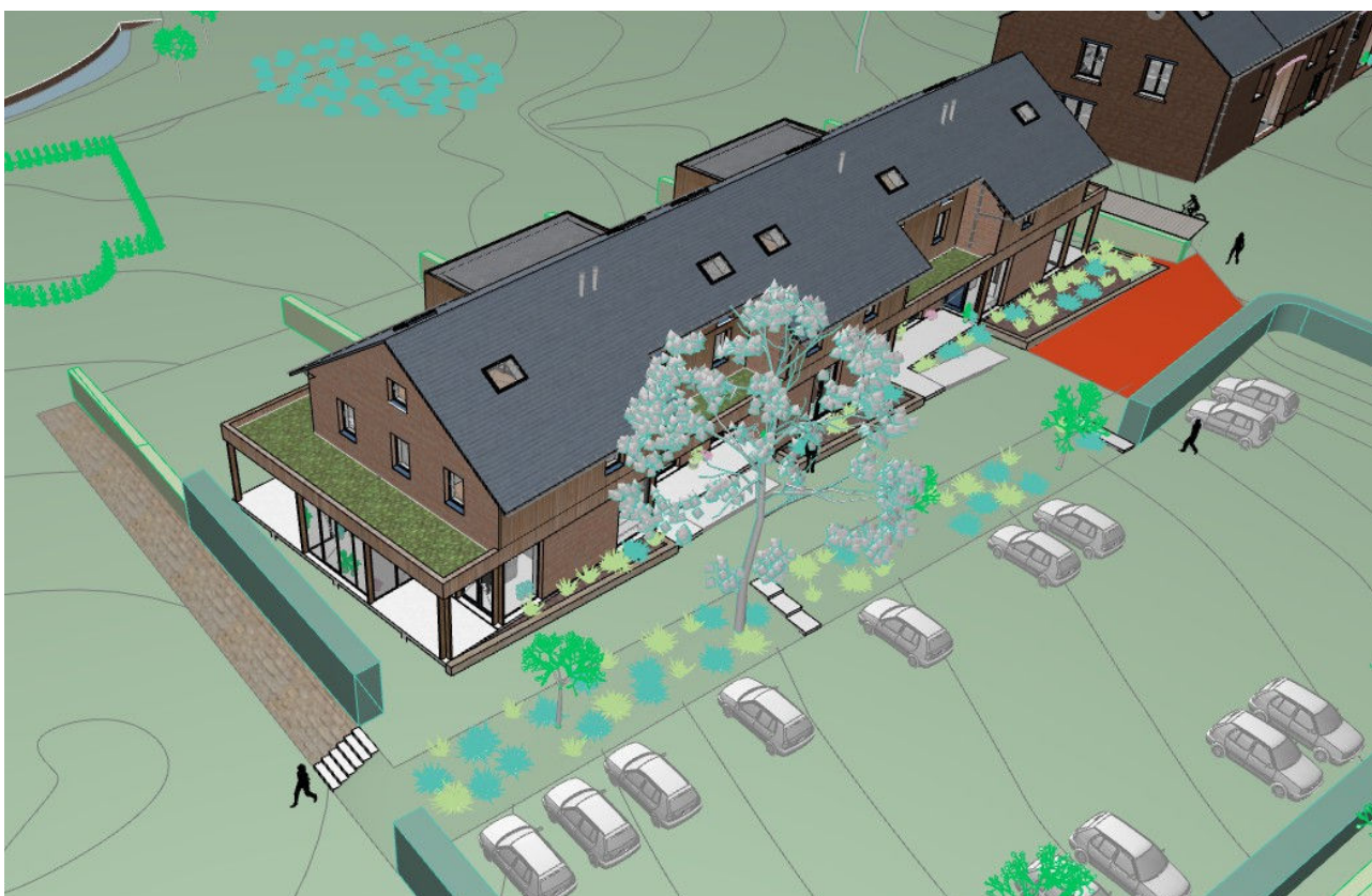
Illustration 8: Rampe PMR (4,5% sur 9m) entre niveau du "plateau" (-1,5m) et niveau existant (-1,1m)
