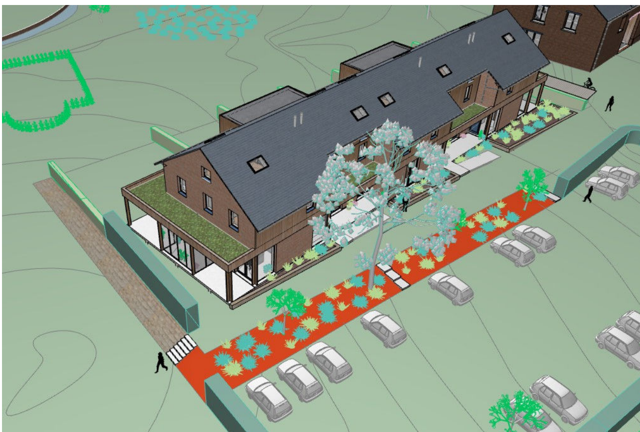
Illustration 6: illustration des talus plantés côté parking rattrapant la différence de niveau variant de 0 (côté ferme) à 91cm côté escalier. Le parking reste au niveau naturel du terrain.
