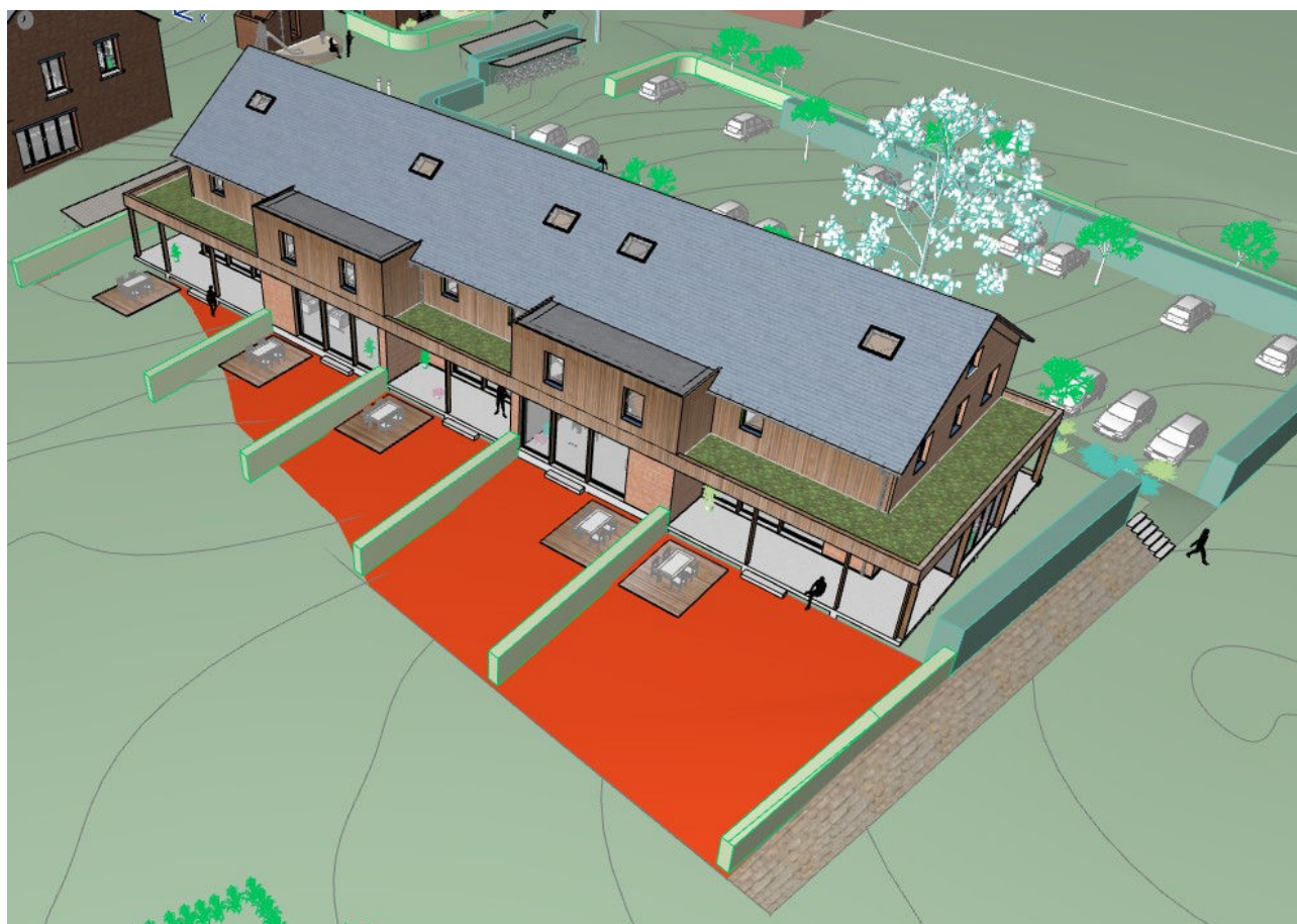
Illustration 4: mise en évidence de la modification des courbes de nivesu -1,6 jusqu'à -2,2 à l'arrière des maisons neuves
